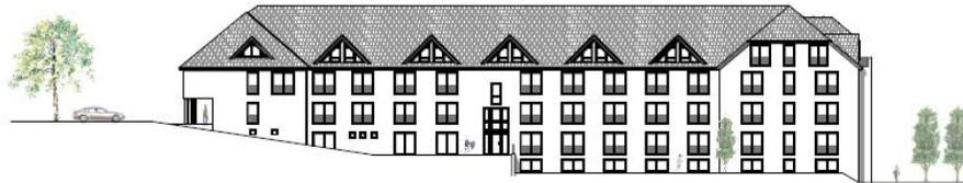
Das von uns geplante Altenpflegeheim wird in Helmstedt errichtet. Durch den vorhandenen, stark abfallenden Geländeverlauf staffelt sich auch das geplante Bauwerk nach unten hin ab. Die dort befindlichen Pflegebereiche werden trotzdem optimal mit Tageslicht versorgt. Die geplante Terrassierung der Außenfläche bietet zudem Platz für verschiedene Garten- und Rückzugsebenen. Auf drei Vollgeschossen bietet das Altenpflegeheim 126 Senioren in 90 Einbettzimmern
